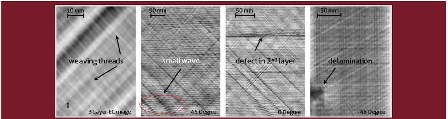
1 Typische Defekte in Kohlefaserverbundmaterial (CFK).
